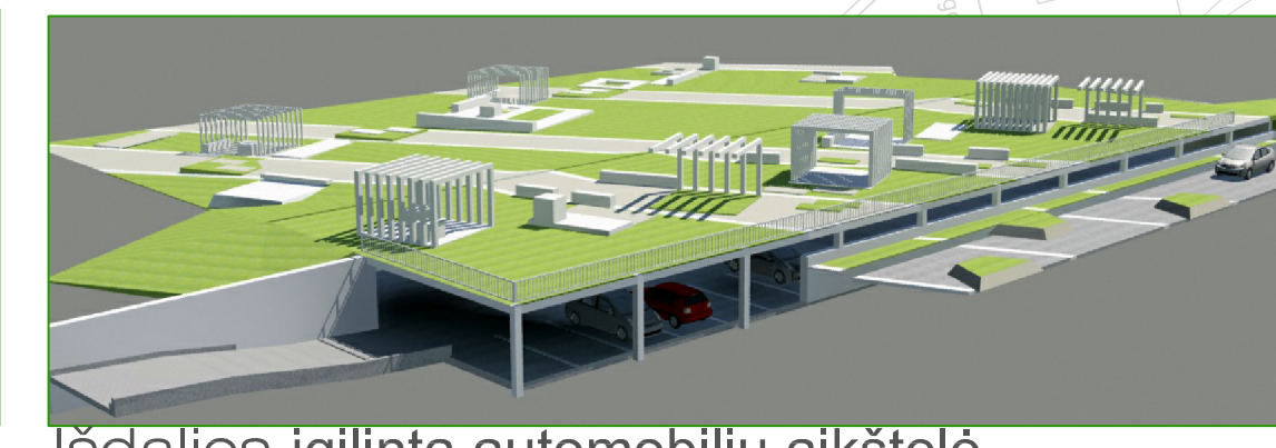
Išdalies įgilinta automobilių aikštelė
